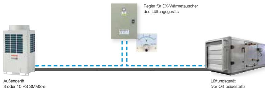
**LÜFTUNGSKIT ABLUFT TEMPERATURSTEUERUNG**
